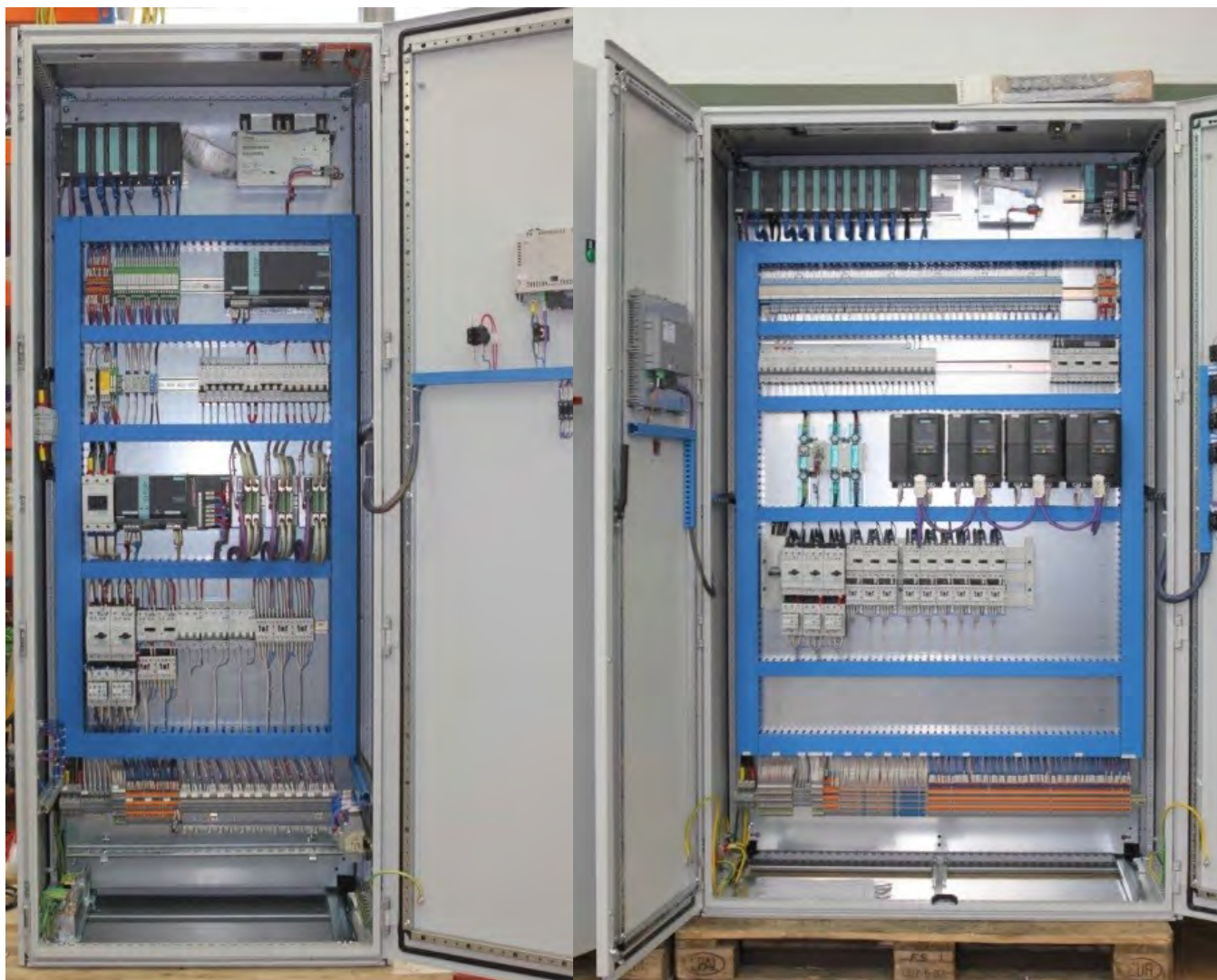
Шкаф управления и контроля объектами АСУТП
